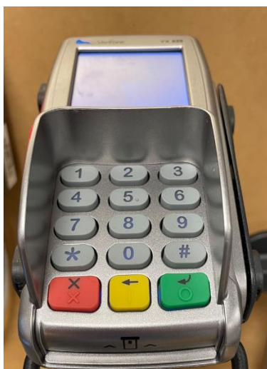
Bild 1–2 VX820, framsida med knappsats och kortläsare/kortinstick
