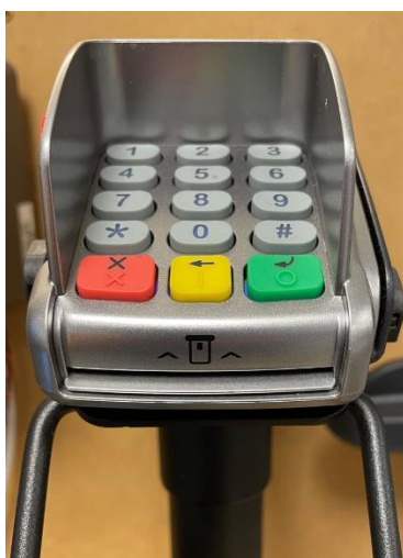
Bild 1–2 VX820, framsida med knappsats och kortläsare/kortinstick
