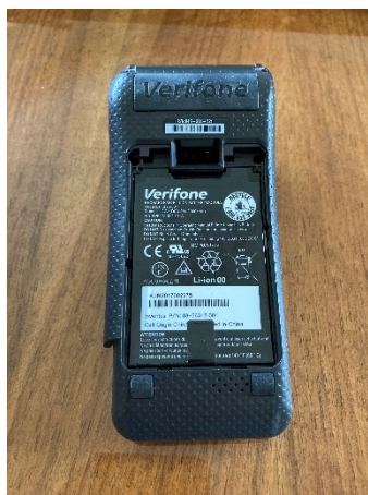
Bild 3–5 V400m, baksida inkl. innanmäte (utseende innanför avtagbar batterilucka)
