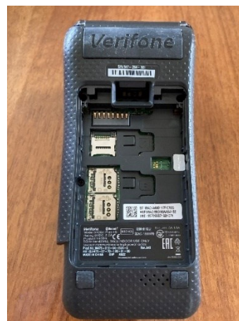
Bild 3–5 V400m, baksida inkl. innanmäte (utseende innanför avtagbar batterilucka)
