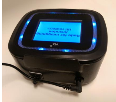
Strömkabel med kontakt
